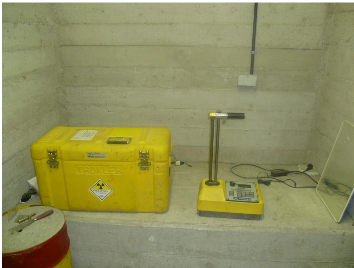
Equipo portátil para medir densidad y humedad del Laboratorio de Control y Calidad del Gobierno de Navarra.
