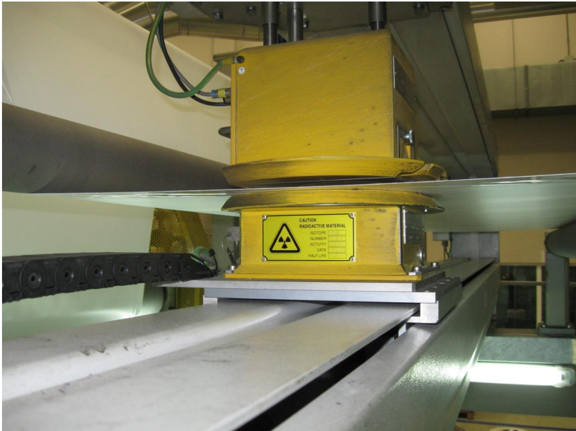
Equipo para medir densidad del plástico (Kr-85, gas) en Renolit de Estella
